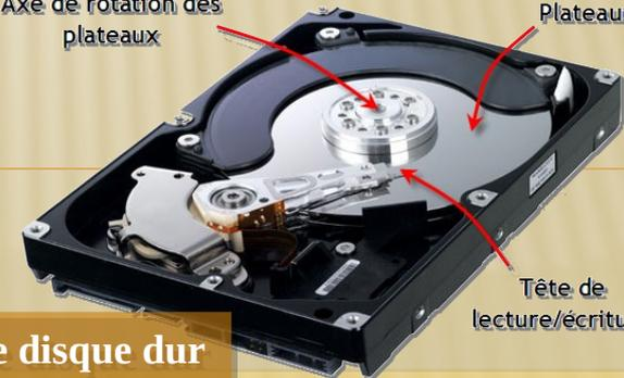
Mécanisme disque dur
