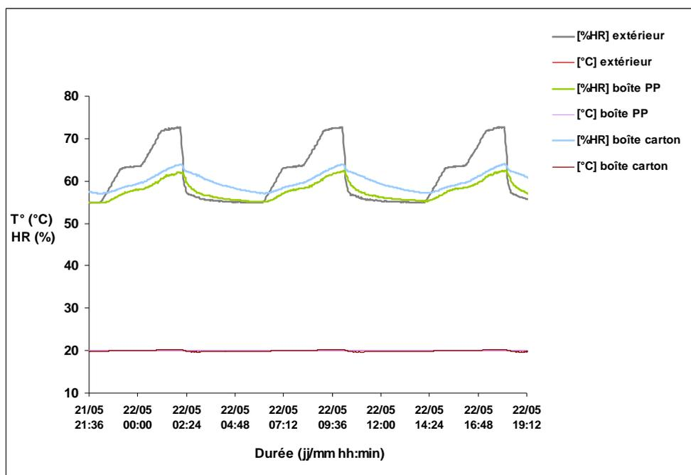
graphe 2. évolution de la température et de l'humidité relative à l'intérieur d'une boîte en PP et d'une boîte en carton contenant un livre, en fonction des variations extérieures.
